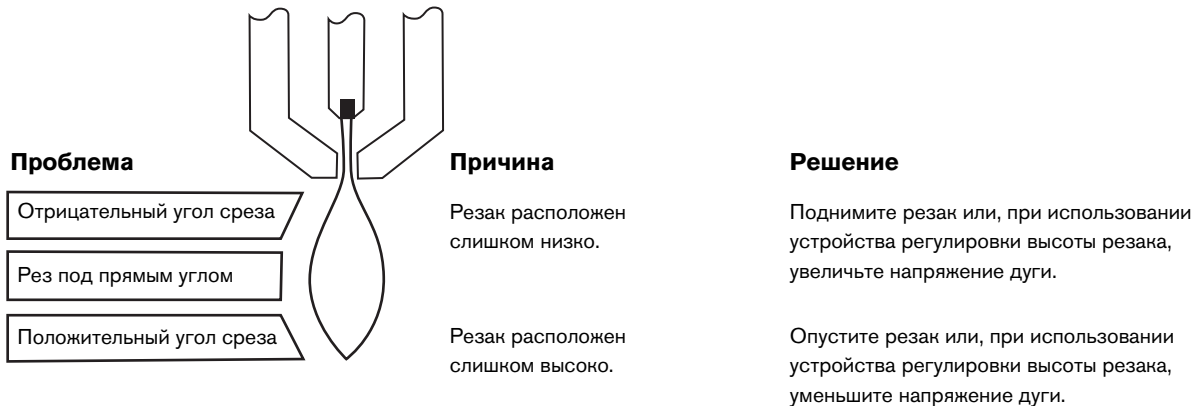
Рисунок 4 – Углы среза
